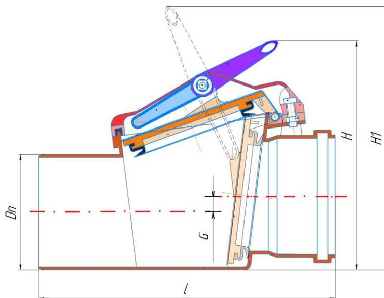
Рисунок 2. Обратный клапан. Габаритные и присоединительные размеры
