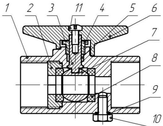
3.1 Запорным органом крана служит шаровая пробка (поз.7), располагающаяся во внутренней полости корпуса (поз.1), приводимая в движение рукояткой (поз.6).
