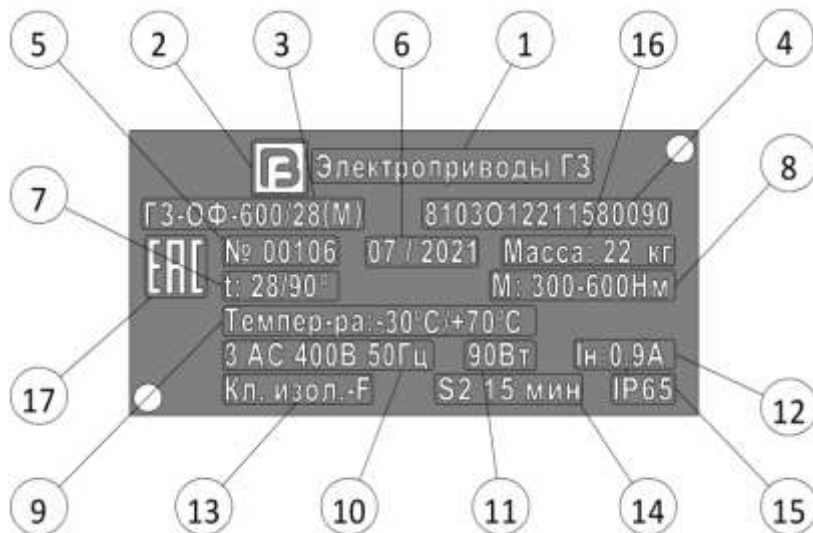
Рисунок 2 – Заводская табличка электропривода (пример)
